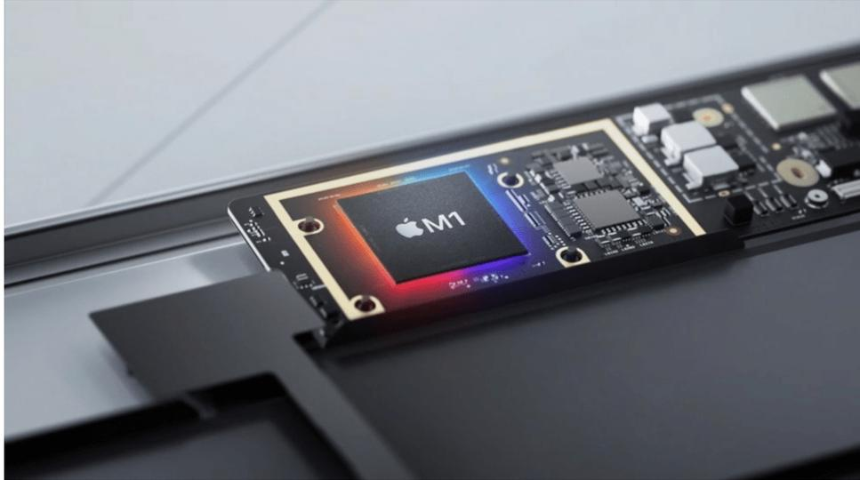
*Integrar chips dentro del procesador reduce la necesidad de transferir datos de un lado a otro a otros chips (externos)*
