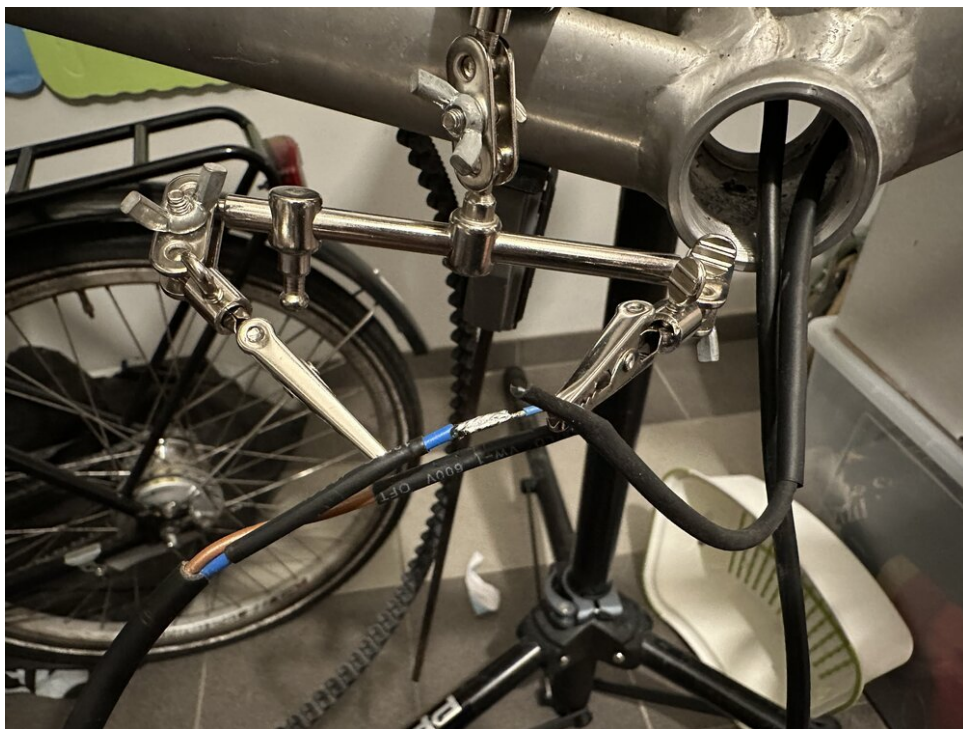
Soldando los cables individuales y cubriéndolos con termorretráctil
