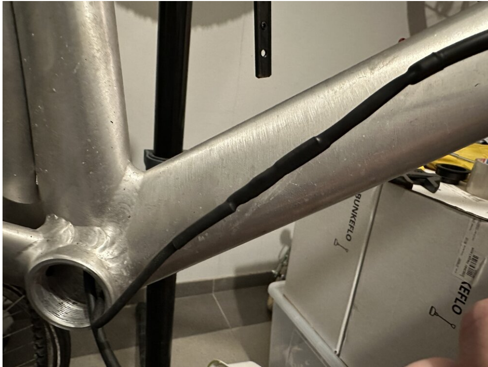
La conexión termorretráctil resultante es funcional y duradera
