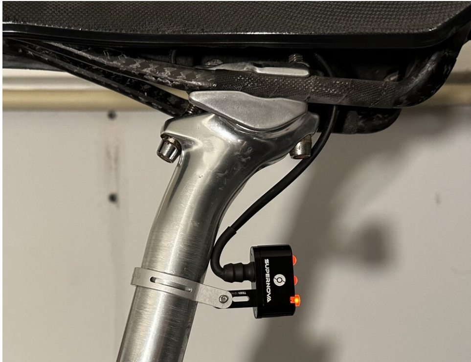
La luz trasera montada en la tija del sillín con su cable pasando por dentro de la tija
