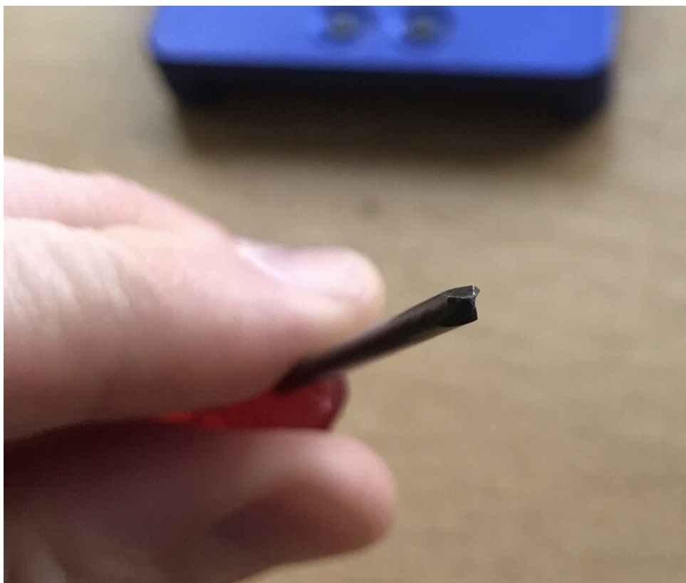
Het juiste gereedschap gebruiken: een Tri-wing driehoekige schroevendraaier
