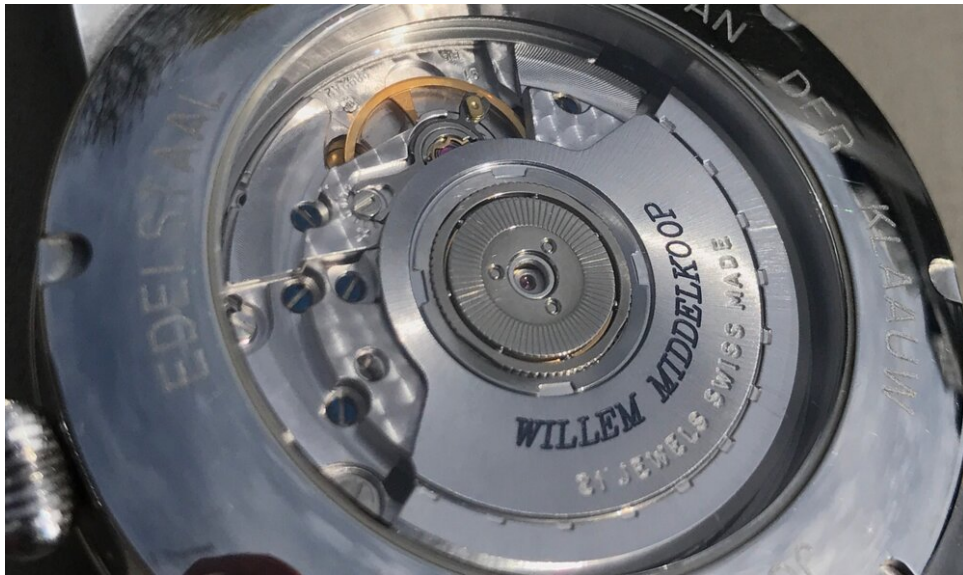
De opwindrotor en het uurwerk van het mechanische horloge, zichtbaar door de saffieren achterkant van de kast
