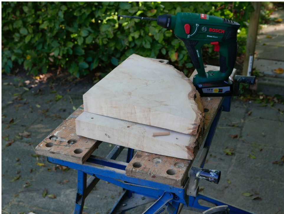
Gaten boren voor de houten pennen
