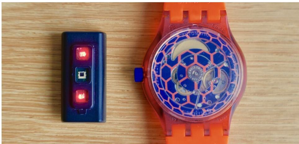
Aan de onderkant zie je de twee rode LED's en de PPG sensor. Net als het Swatch Sistem51 uurwerk is dit verborgen wanneer gedragen op de pols
