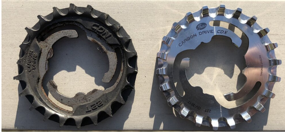
Links het plastic CDN tandwiel - als je goed kijkt zie je de missende tanden, rechts het glimmende roestvrijstalen CDX tandwiel
