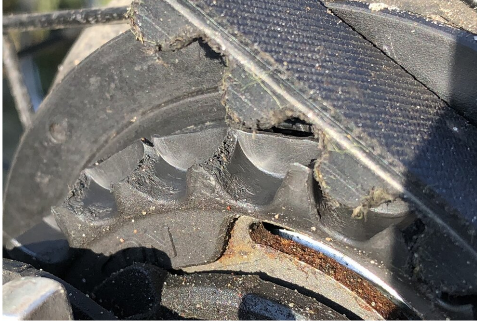
Gates Carbon Drive achtertandwiel met overmatige slijtage na slechts 1800KM
