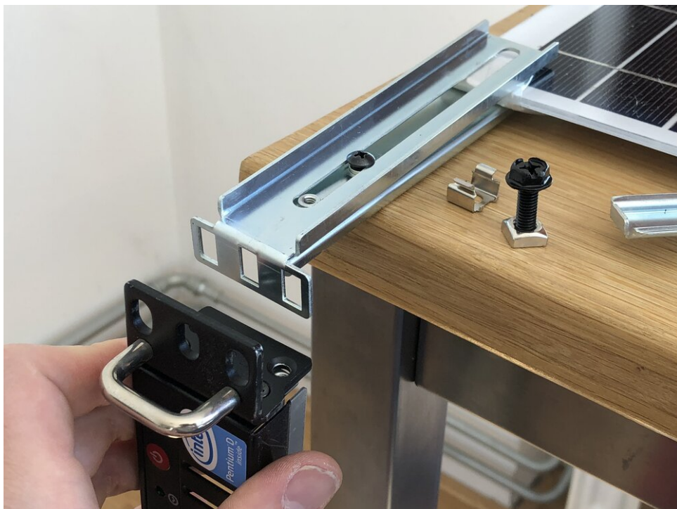
Ooit de voorkant van een server, nu onderdeel van de zonnepaneelbevestiging
