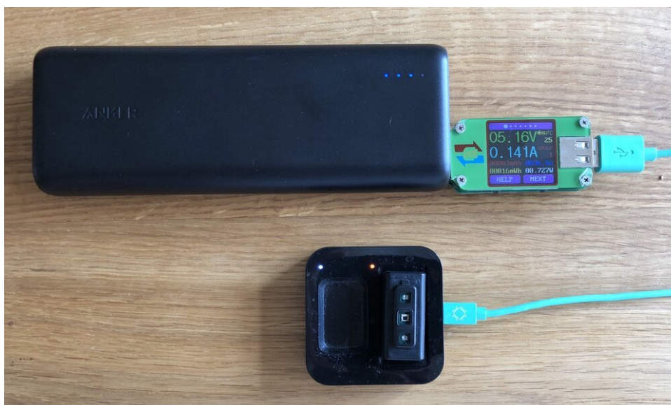
Biostrap opladen met zonne-energie van de Anker-powerbank
