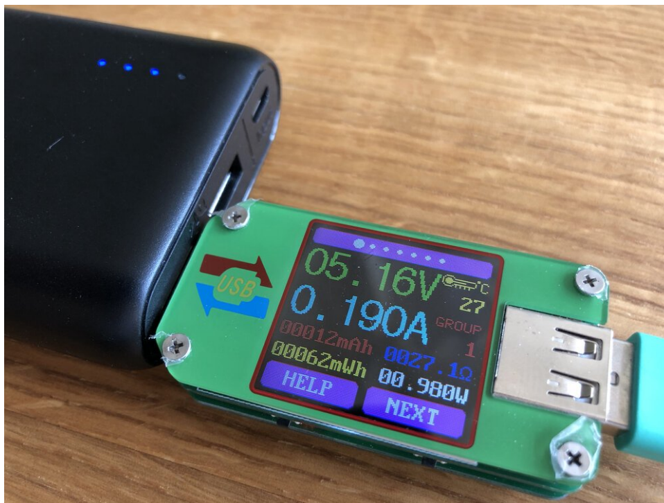
Energieverbruik meten met een inline USB-stroommonitor
