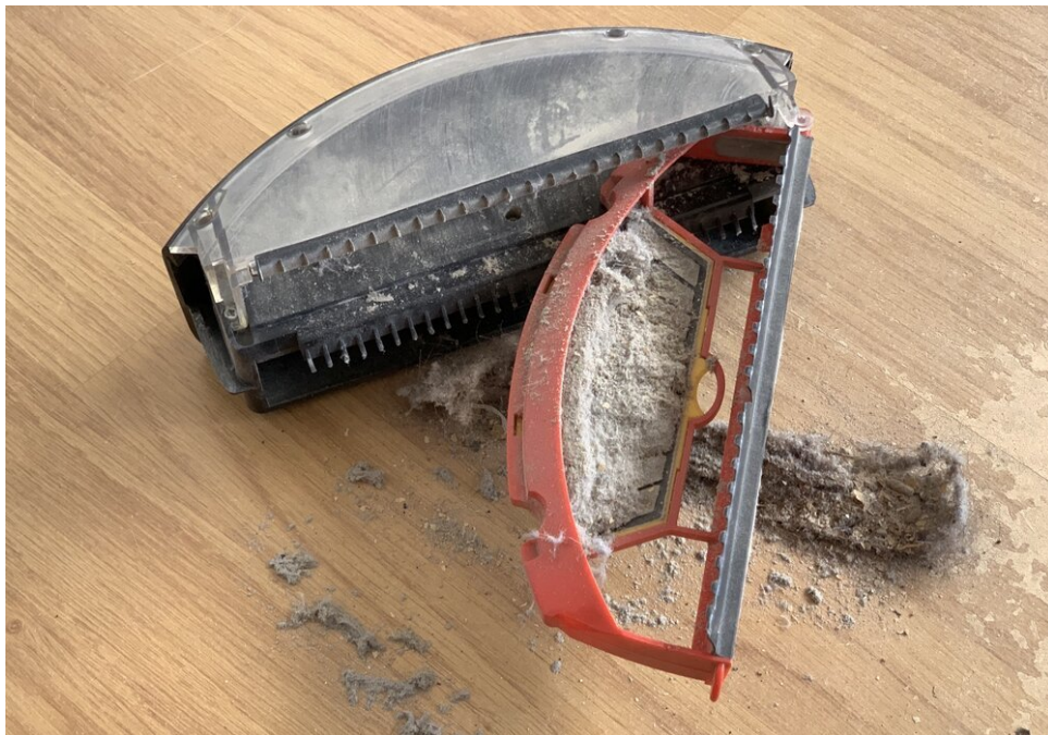
Verwijder stof uit de container door het filter eruit te schuiven
