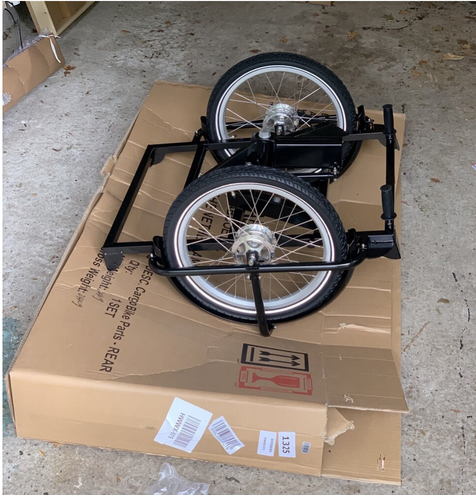
Voorwielen aan het frame bevestigen
