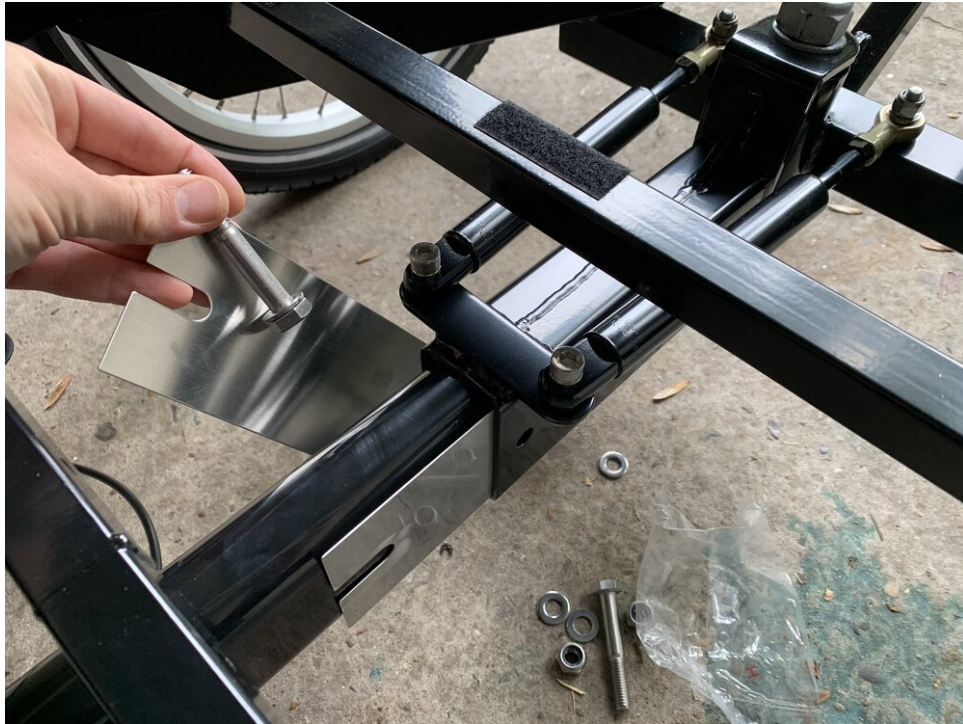
Vulplaatjes gebruiken om Chinese Precisie te compenseren
