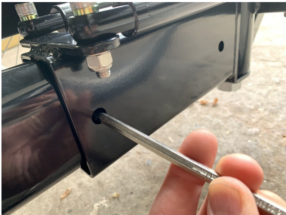
Een inbussleutel gebruiken om het vulplaatje op zijn plaats te duwen, waardoor het boutgat vrijkomt
