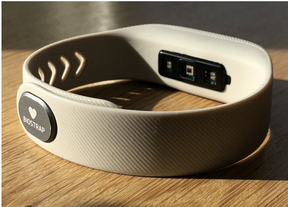
Biostrap heeft een optische sensor, in het midden, precies tussen twee LED's
