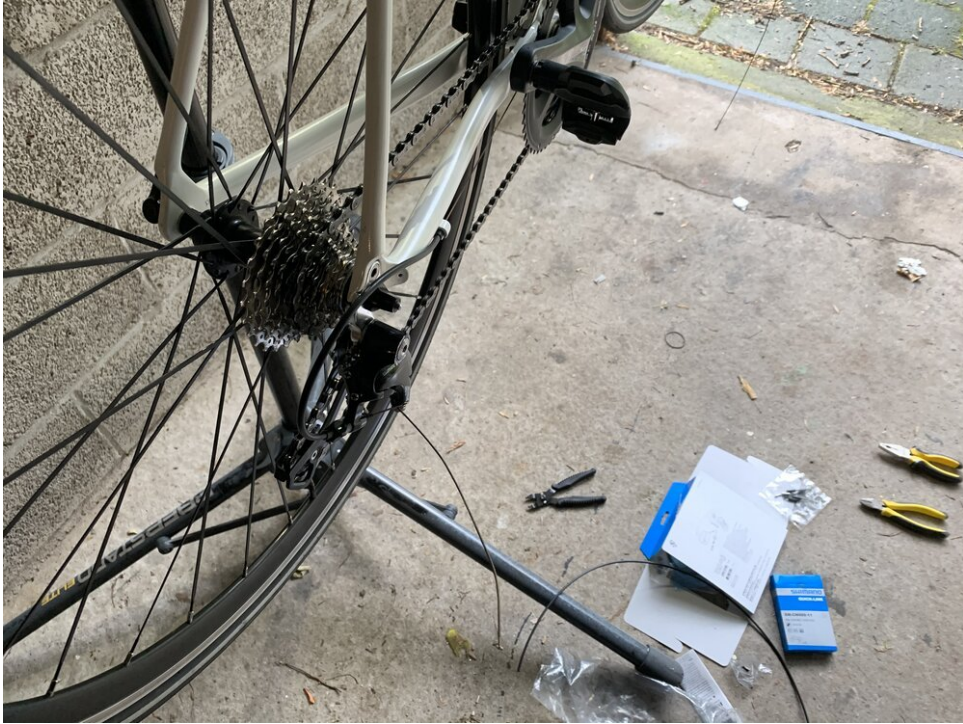
De kabels aansluiten op de derailleurs
