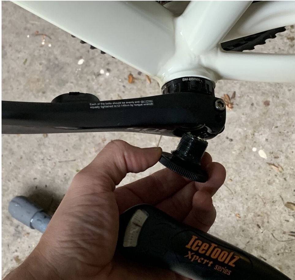
De crank monteren met een momentsleutel en cranksleutel - let op de geschreven instructies op de crank
