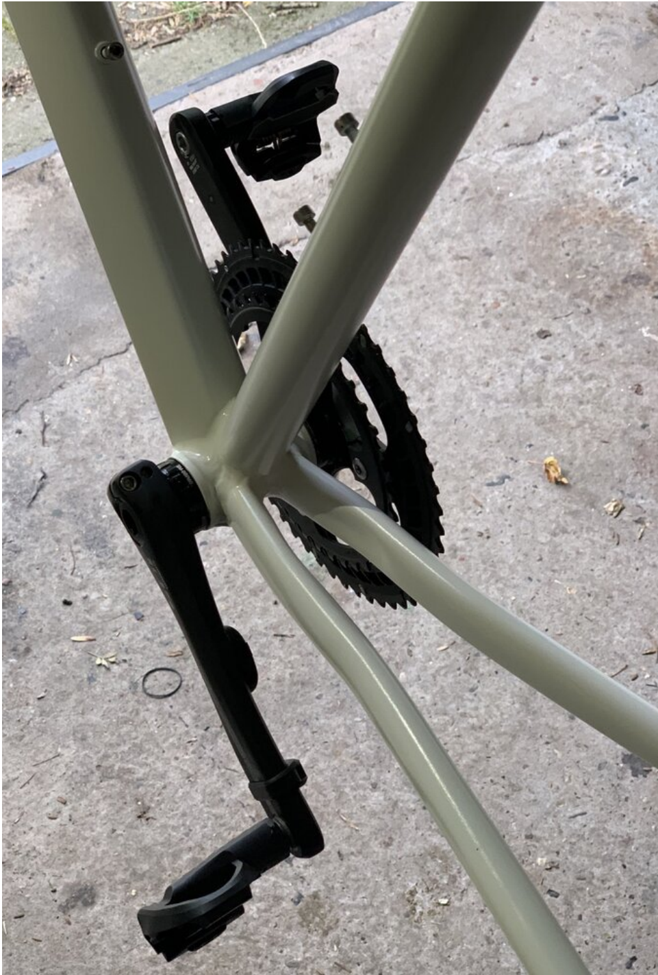
Crank en pedalen gemonteerd op het fietsframe - controleer of het vrij kan bewegen
