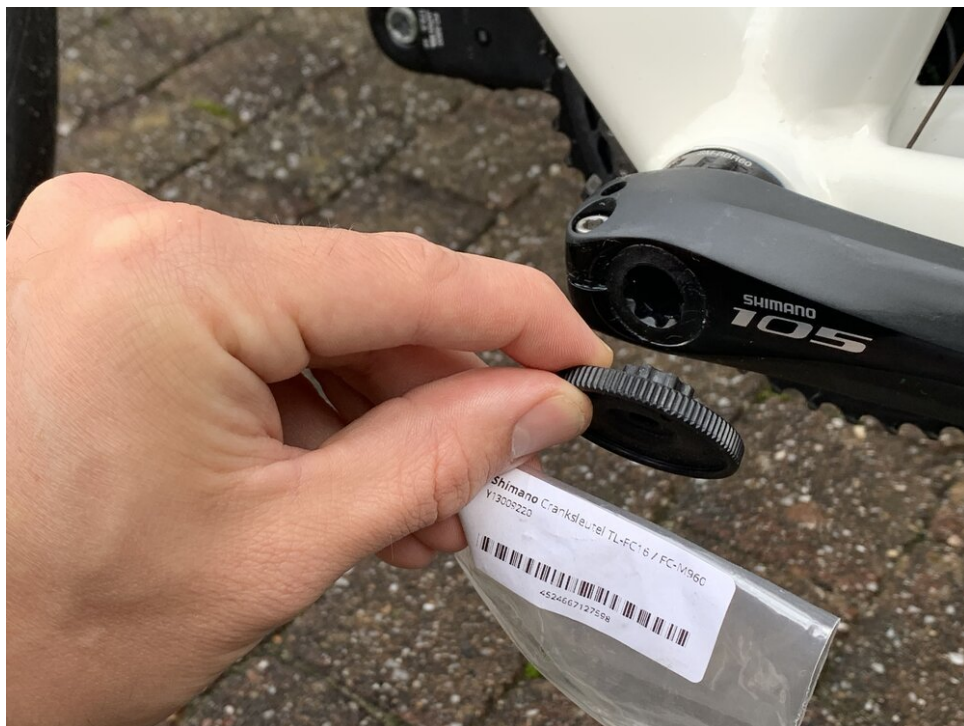
Gebruik een cranksleutel om de crank te verwijderen (Shimano TL-FC16 / FC-M960)
