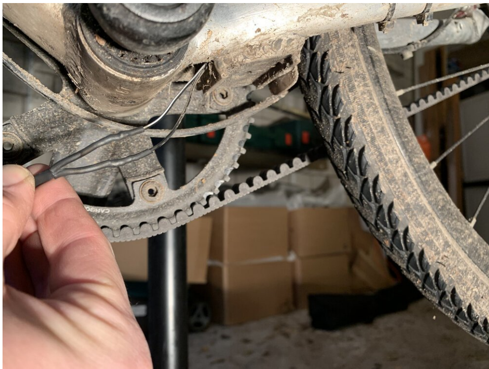
Na het verwarmen van de krimpkous, bieden ze een beschermende laag tegen de elementen
