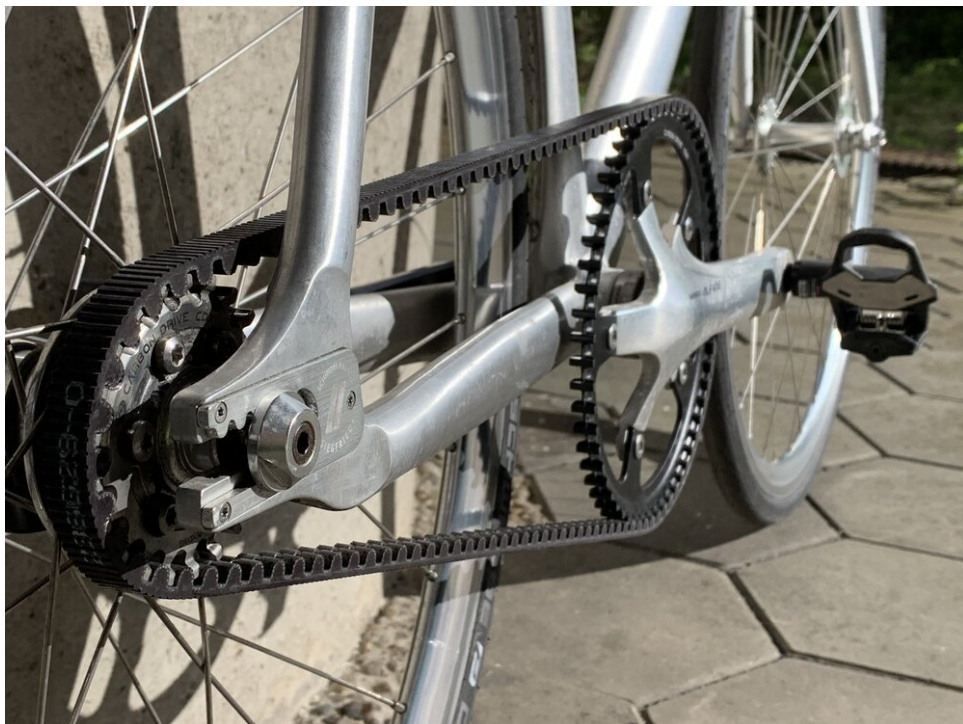
Zonder de conventionele derailleurs is de aandrijving vrij eenvoudig (60T/22T overbrengingsverhouding)
