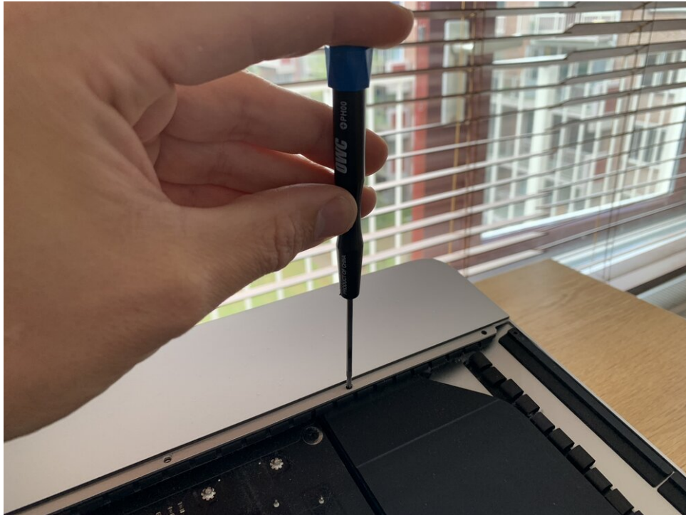
Schroeven verwijderen van de iMac
