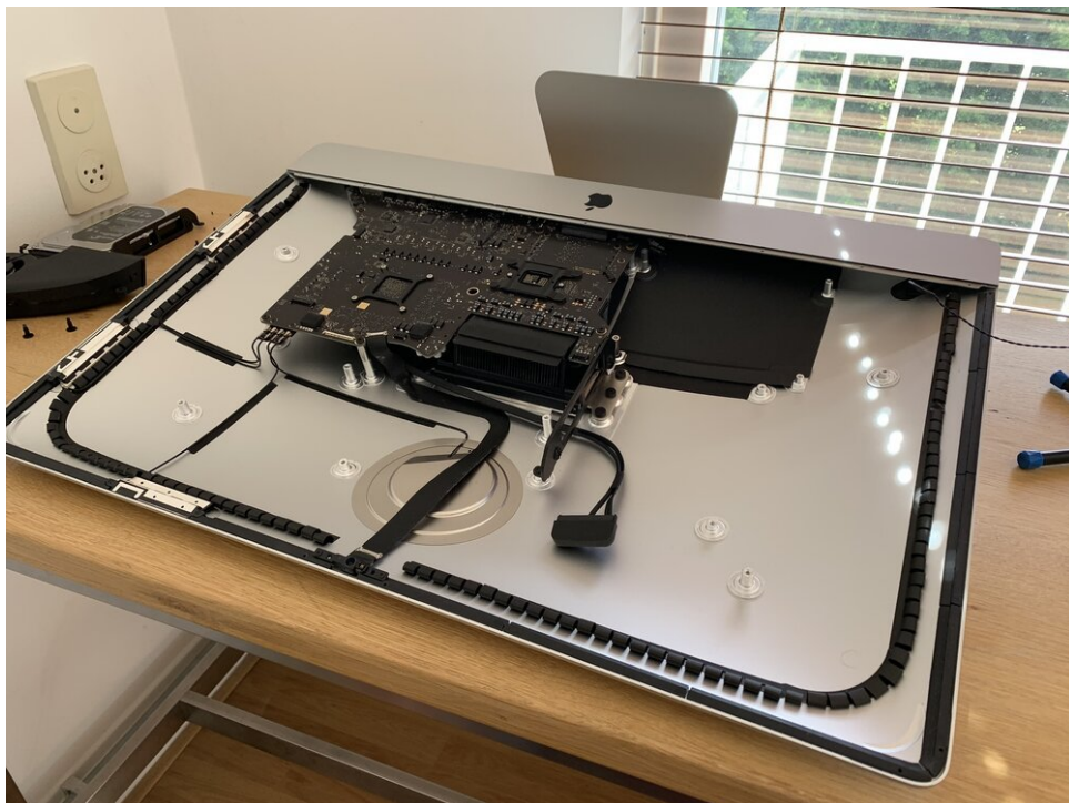
Werk in uitvoering: de meeste onderdelen zijn verwijderd, het logic board blijft over
