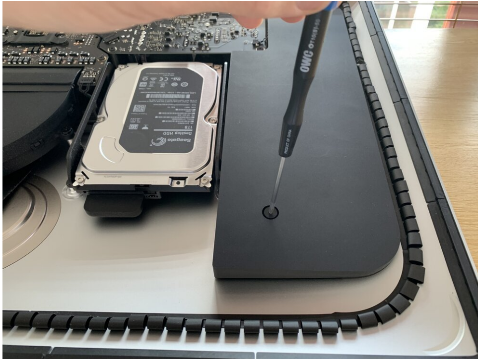
Een iMac-luidspreker verwijderen
