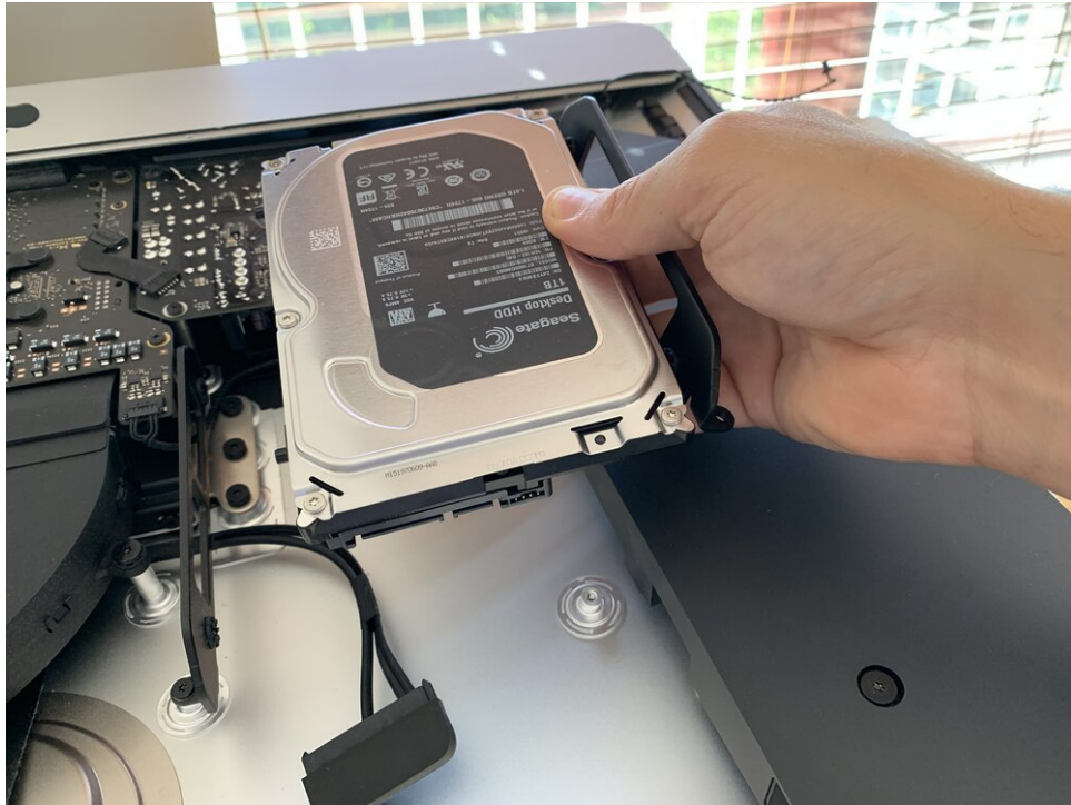
De Fusion Drive 1TB harde schijf verwijderen
