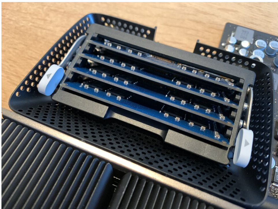
De RAM-modules migreren naar het nieuwe logic board
