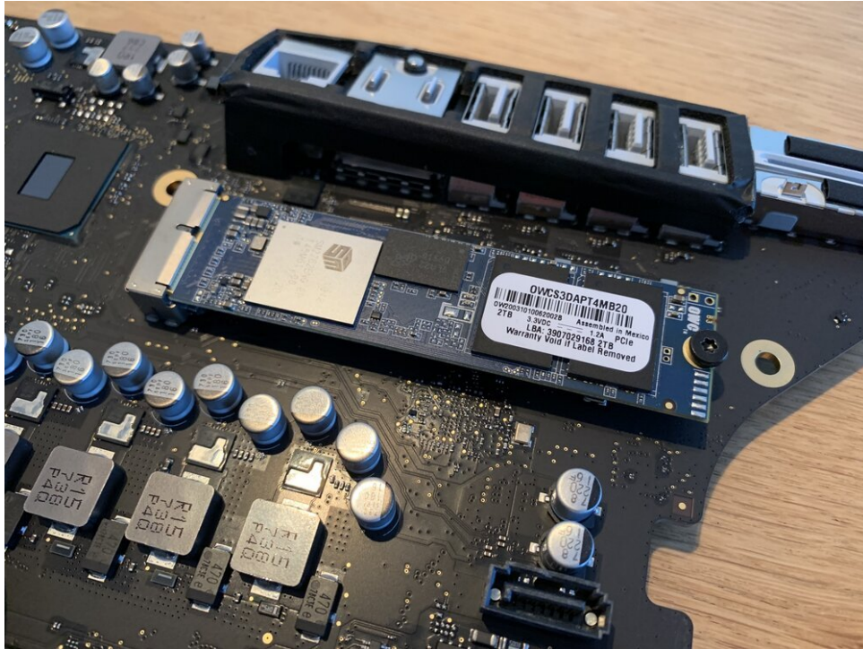
Dubbel, driedubbel, viervoudig controleren van de PCIe SSD
