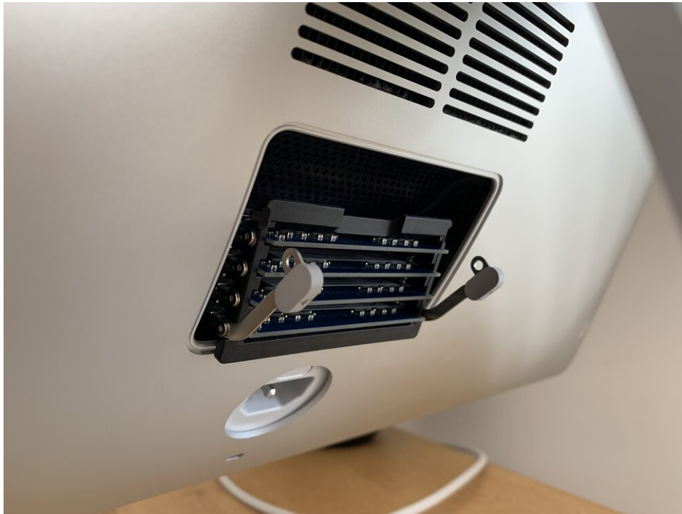
Het RAM-klepje springt open met de geheime knop in de voedingsconnector
