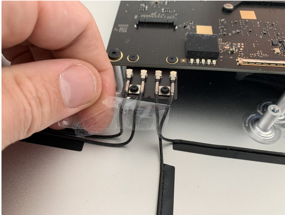
De antennekabels verwijderen, onthoud hun volgorde met een stukje tape
