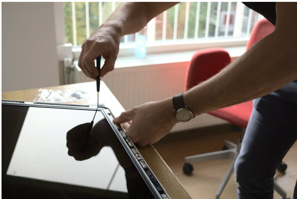
Het scherm is bevestigd met Torx-schroeven - het kan een beetje lastig zijn om de schroeven te verwijderen omdat de magneten ze makkelijk opvangen!
