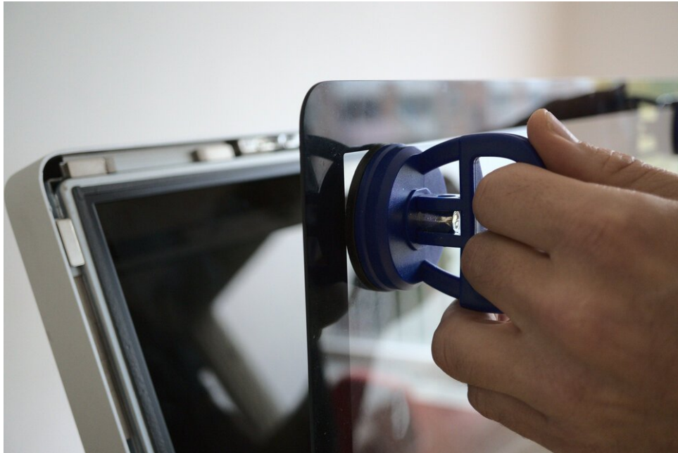
Het glaspaneel verwijderen met behulp van zuignappen
