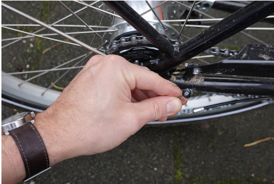
De bout die de schakelkabel vasthoudt, trok uit de beugel bij de versnellingsnaaf
