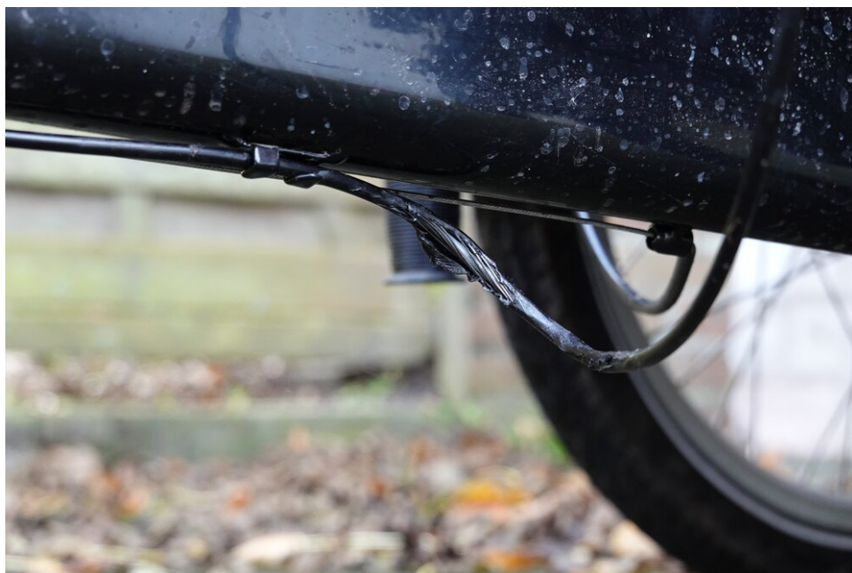
De schakelkabel onder de bakfiets werd door een tak uit elkaar getrokken...
