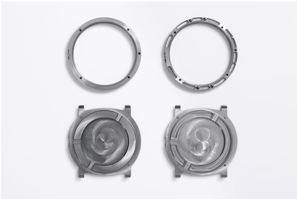
Voor (links) en na (rechts) het wegfrezen van materiaal
