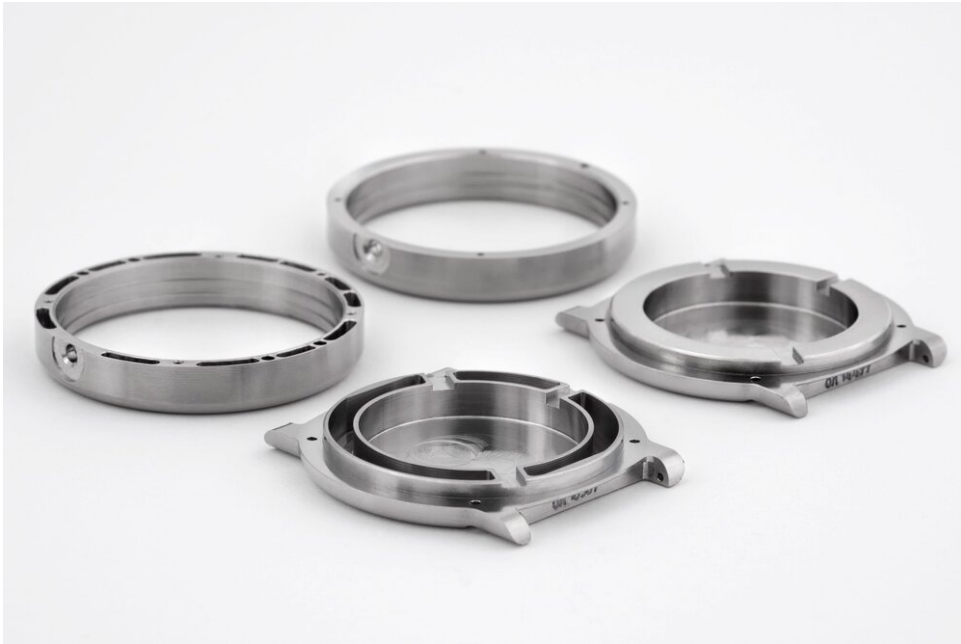
Materiaal wegfrezen om het horloge lichter te maken
