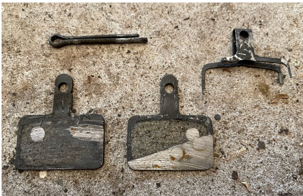
Mijn hydraulische remblokken waren versleten! Let op de beschadigde vork rechtsboven (die de remblokken op hun plaats moet houden)
