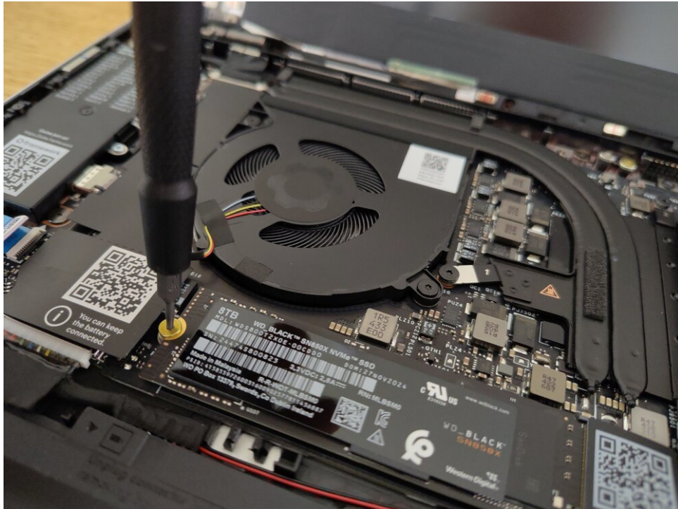
De 8TB SSD is bevestigd met een enkele schroef
